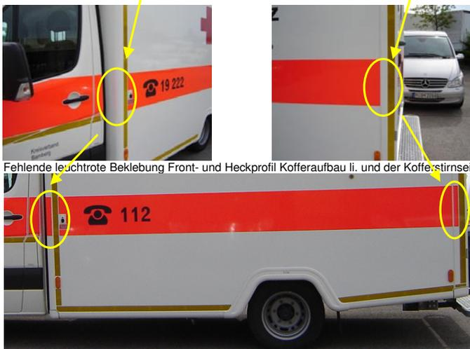
Fehlende leuchtrote Beklebung Front- und Heckprofil Kofferaufbau li. und der Koffeirstirnseite
