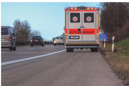
Im Exterieur liegen die Neuerungen vor allem im Bereich der optischen Signalanlage und der Rückwärts-Absicherung.
